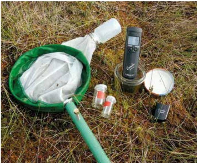
Abb. 5.1: Die Abbildung zeigt das Planktonnetz mit einer Teleskopstange (ausziehbar bis 2,90 m), Probengläser unterschiedlicher Größe und einen Kombi-Tester für die Messung von pH-Wert und Leitfähigkeit.
